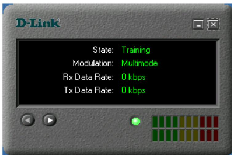
Ярко зеленый свет под экраном указывает на действующее соединение. На экране указывается текущее состояние модема, модуляция и скорость получаемых и передаваемых данных. Во время запуска модем автоматически соединяется (trainig), загружает настройки в модеме. Вскоре после этого процесса появится приведенный ниже экран, уже указывающий на состояние получаемых данных.
