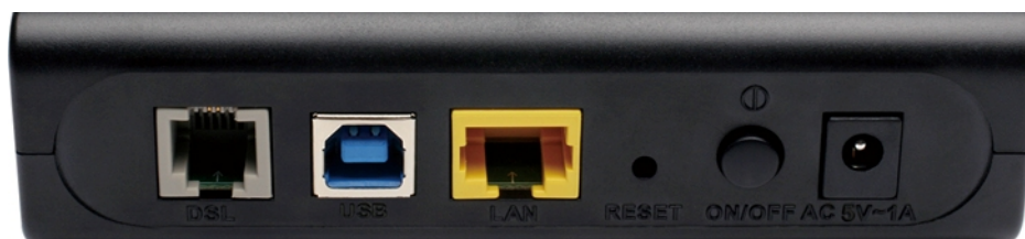
Рисунок 2. Вид задней панели DSL-2520U.
