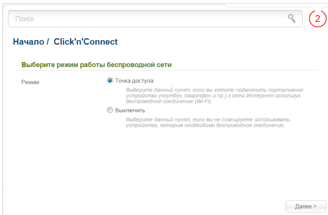
Рисунок 36. Выбор режима работы беспроводной сети.
