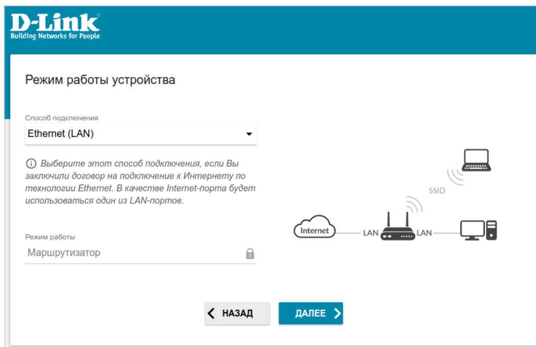
Рисунок 24. Выбор режима работы устройства. Режим Ethernet (LAN) .
