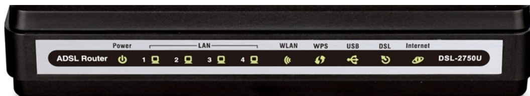
Рисунок 1. Вид передней панели DSL-2750U.
