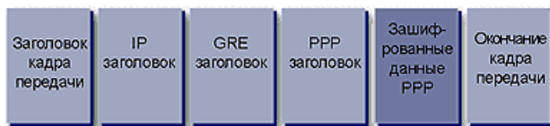
Рисунок 3. Структура данных для пересылки по туннелю PPTP.
