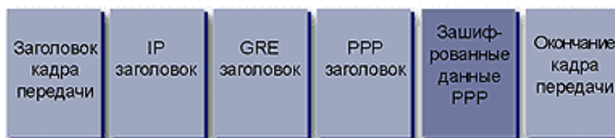
Рисунок 3. Структура данных для пересылки по туннелю PPTP.
