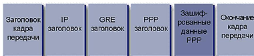
Рисунок 3. Структура данных для пересылки по туннелю PPTP.
