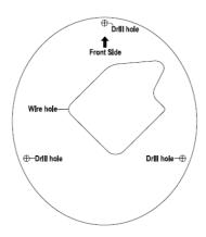
2) Используя монтажные отверстия на внутренней части кронштейна и входящие в комплект поставки винты, прикрепите DCS-37-3 к потолку.
