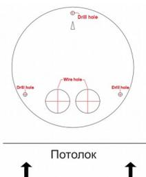
Совместите нижнюю панель основания камеры с просверленными отверстиями на потолке и вставьте винты в анкеры. Вкрутите винты с помощью отвертки.
