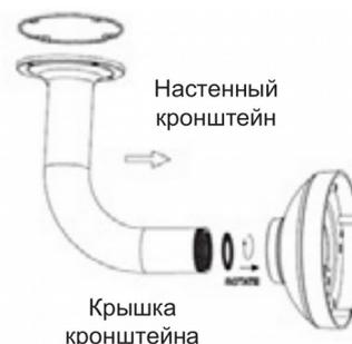
Поместите резиновый уплотнитель между настенным кронштейном и потолком для обеспечения водонепроницаемости между потолком и кронштейном.
