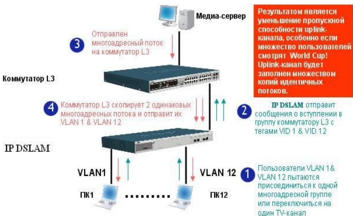
Рисунок 7-4. Вещание мультикаст потоков без использования MVLAN
