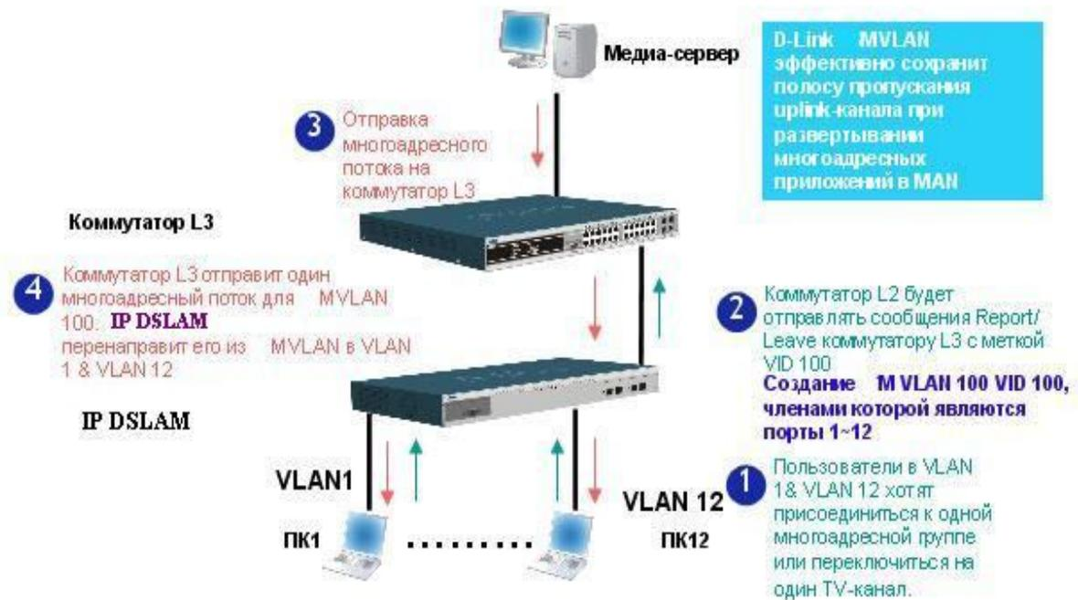
Рисунок 7-5 Вещание мультикаст потоков с использованием MVLAN
