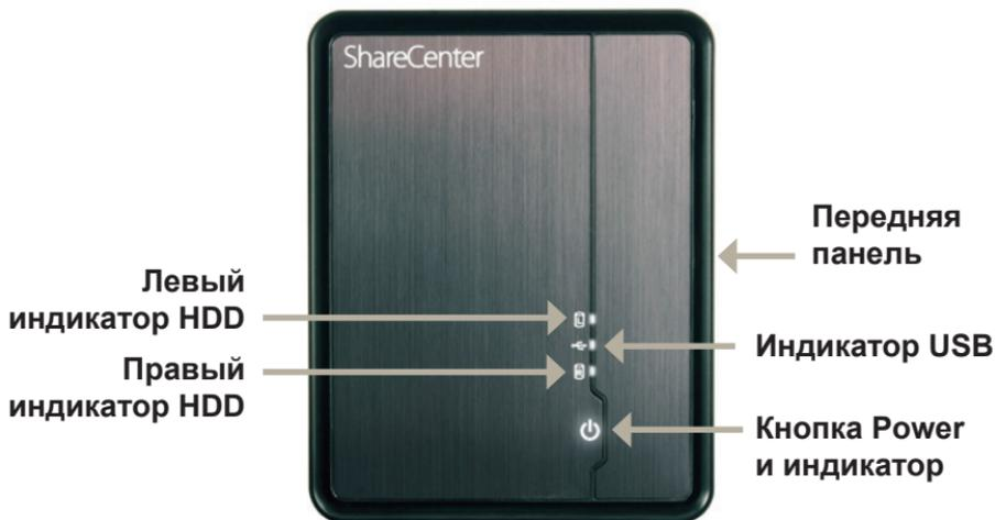
**Левый и правый индикаторы HDD:** Индикаторы будут гореть постоянным белым светом, когда диски подключены и бездействуют. Они будут мигать, когда к дискам получают доступ, и при их форматировании или синхронизации. Индикаторы будут гореть желтым светом при ошибке диска.
