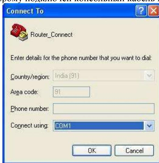
Установите параметры соединения следующим образом: скорость передачи 9600 бод, 8 бит, 1 стоп-бит, без контроля четности, без контроля потока:
