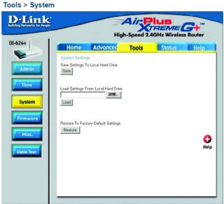
Текущие параметры системы можно сохранить как файл на локальном жестком диске. Сохраненный файл и другие сохраненные конфигурационные файлы затем можно загрузить обратно на маршрутизатор. Для загрузки конфигурационного файла на маршрутизатор нажмите кнопку **Browse** для поиска и выбора файла на локальном диске. Кроме того, можно выполнить сброс маршрутизатора к параметрам, установленным по умолчанию, нажав кнопку **Restore**.
