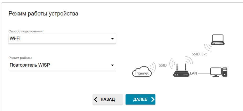
Рисунок 35. Выбор режима работы устройства. Режим Повторитель WISP .
