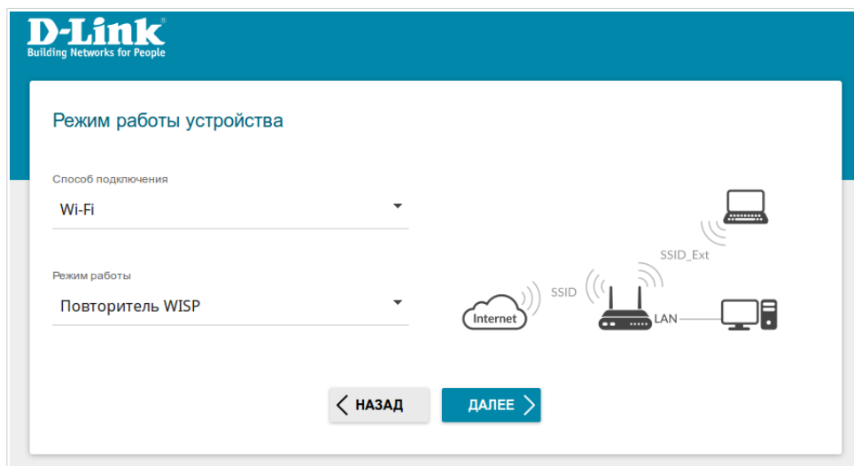
Рисунок 25. Выбор режима работы устройства. Режим Повторитель WISP .
