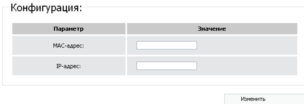
Рисунок 35. Создание связки MAC-адреса и IP-адреса.
