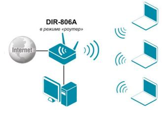
Устройство DIR-806A в режиме «роутер» подключено к выделенной Ethernet-линии или к кабельному или DSL-модему. Компьютеры подключаются к DIR-806A через проводное или беспроводное соединение.
