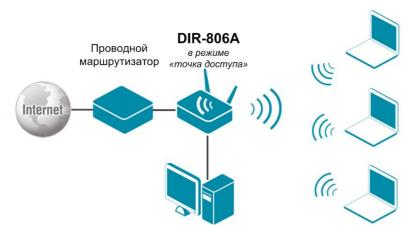
Устройство DIR-806A в режиме «точка доступа» подключено к проводному маршрутизатору. Компьютеры подключаются к DIR-806A через проводное или беспроводное соединение. Необходимо настроить одинаковые параметры шифрования и канал беспроводной сети для DIR-806A и компьютеров с Wi-Fi-адаптерами.
