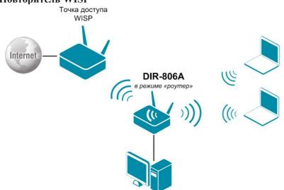
Устройство DIR-806A в режиме «роутер» подключено к точке доступа беспроводного Интернет-провайдера (WISP) по беспроводному соединению. Компьютеры подключаются к DIR-806A через проводное или беспроводное соединение.
