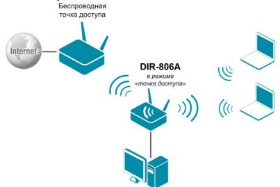
Устройство DIR-806A в режиме «точка доступа» подключено к точке доступа по беспроводному соединению. Компьютеры подключаются к DIR-806A через проводное или беспроводное соединение.
