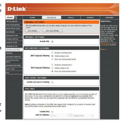
**Примечание:** Размещение компьютера в зоне DMZ подвергает компьютер различным рискам. Активировать эту функцию рекомендуется рекомендуется только в крайнем случае.
