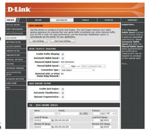
По умолчанию на маршрутизаторе установлена автоматическое определение соединения такого, как xDSL/Frame-relay или любого другого типа соединения (такого как кабельный или Ethernet модем) и здесь будут отображаться обнаруженные сети. Если имеется другой тип сетевого соединения, который использует xDSL-соединение, но для него требуется настройка параметров Интернет "Static" или "DHCP", то настройте параметры как для сети xDSL или Frame Relay, это обеспечит нормальную работу маршрутизатора.
