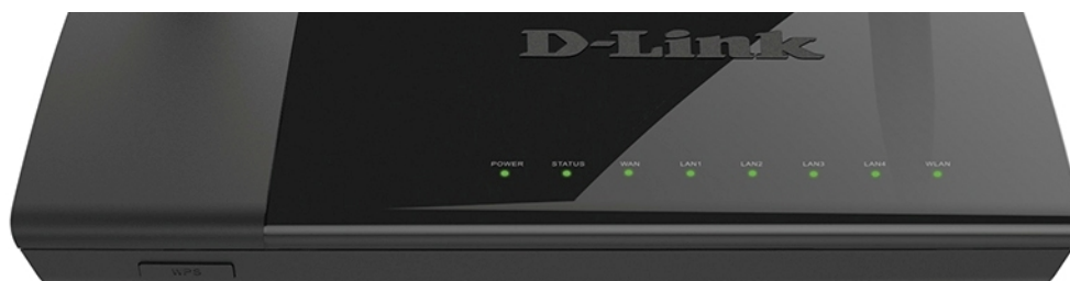
Рисунок 1. Вид верхней панели DIR-825/AC.
