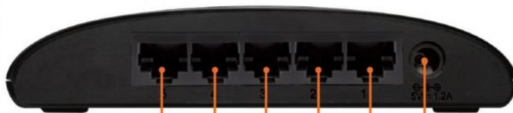
5 ПОРТОВ 10/100 BASE-TX С РАЗЪЕМОМ RJ-45
