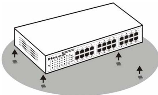
*Установка коммутатора Fast Ethernet на рабочий стол или поверхность.*
