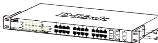
Рисунок 2. Крепление монтажных уголков
