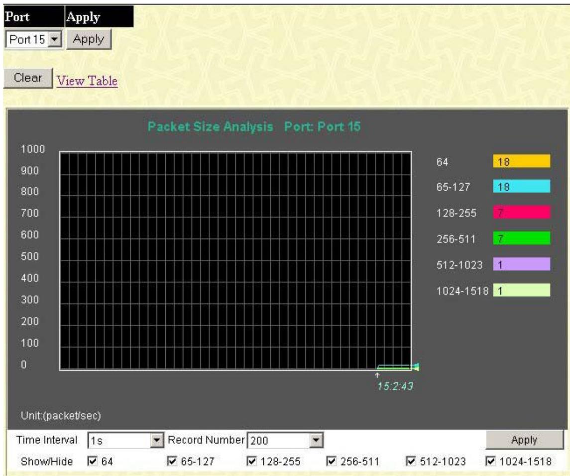
**Рисунок 11.13 – Окно Rx Size Analysis (график зависимости)**
