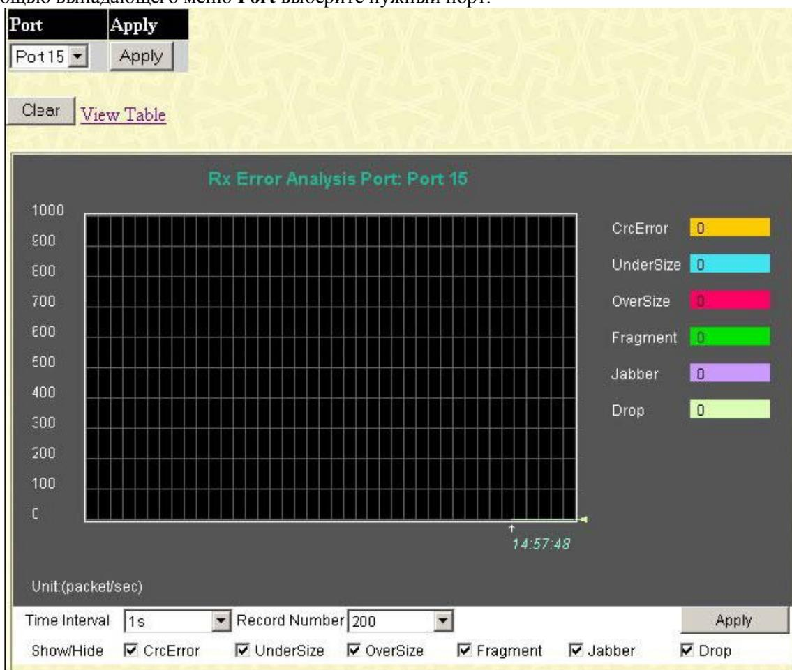
Рисунок 11.9 – Окно Rx Error Analysis (график зависимости)
