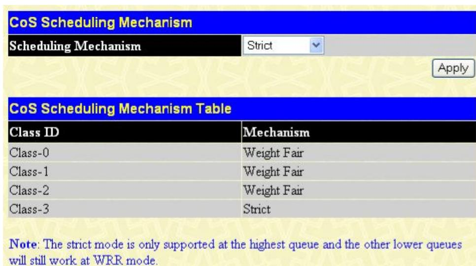
Рисунок 8- 5. Окно CoS Scheduling Mechanism и CoS Scheduling Mechanism Table
