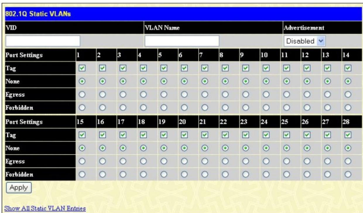
Рисунок 7- 5. Окно 802.1Q Static VLAN - добавить
