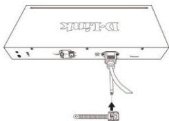
Рисунок 3-3. Установка зажима на стяжку
