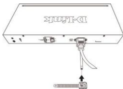
Рисунок 3-3. Установка зажима на стяжку
