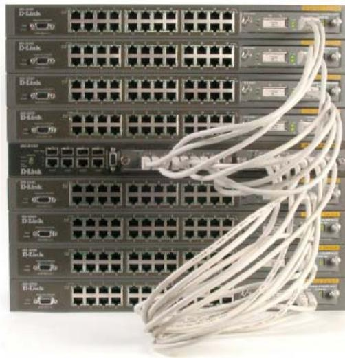
Стек из 8 коммутаторов DES-3226S, подключенных к мастер-коммутатору DGS-3212SR (в середине стека)
