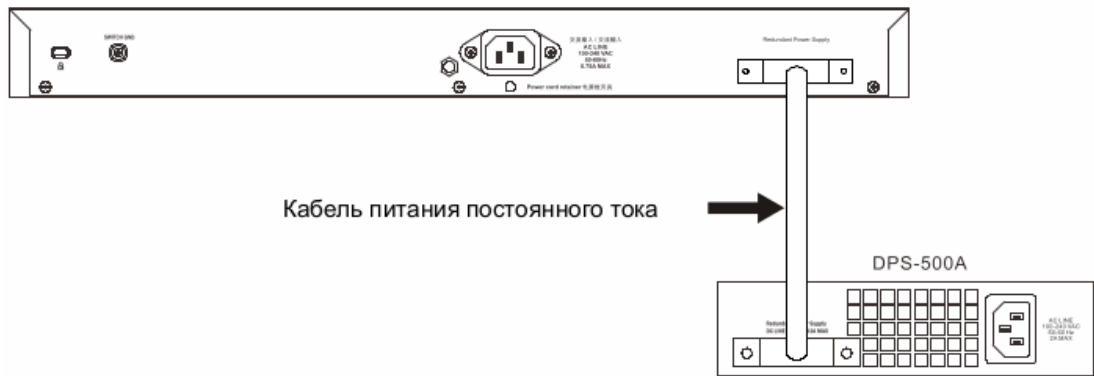
Рисунок 10 — Подключение DPS-500A к коммутатору
