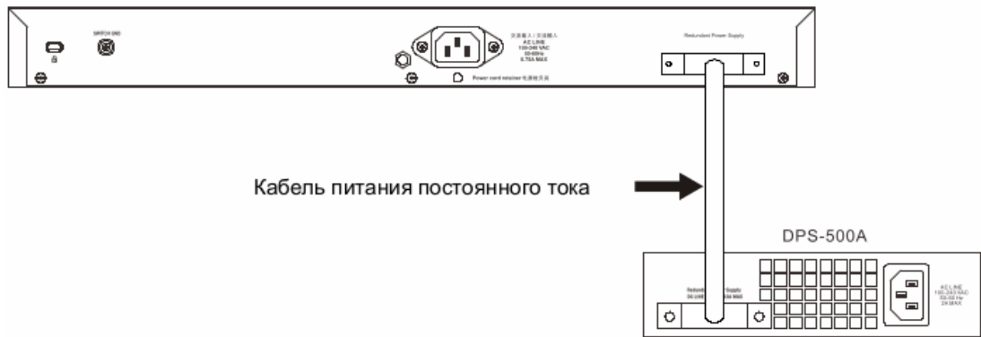
Рисунок 10 — Подключение DPS-500A к коммутатору
