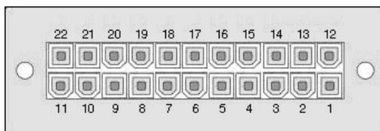
**Рисунок 2.4 — Назначение контактов разъема RPS на коммутаторе, поддерживающем подключение DPS-700**
