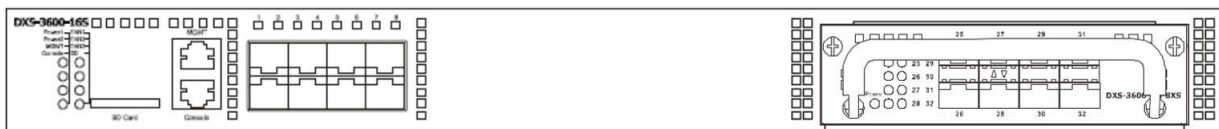
Передняя панель коммутатора DXS-3600-16S с модулем EM-8XS
