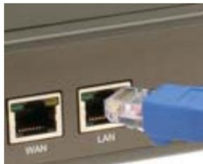
d. Подключите кабель Ethernet, который был отсоединен из модема, к одному из четырех портов LAN на задней панели DVG-3032S. Другой конец оставьте подключенным к компьютеру.
