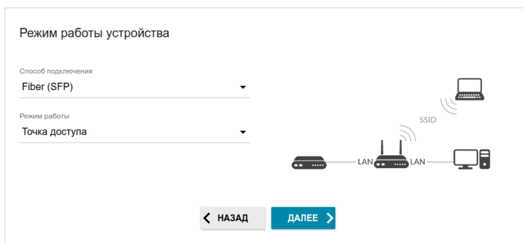
Рисунок 37. Выбор режима работы устройства. Режим Точка доступа.
