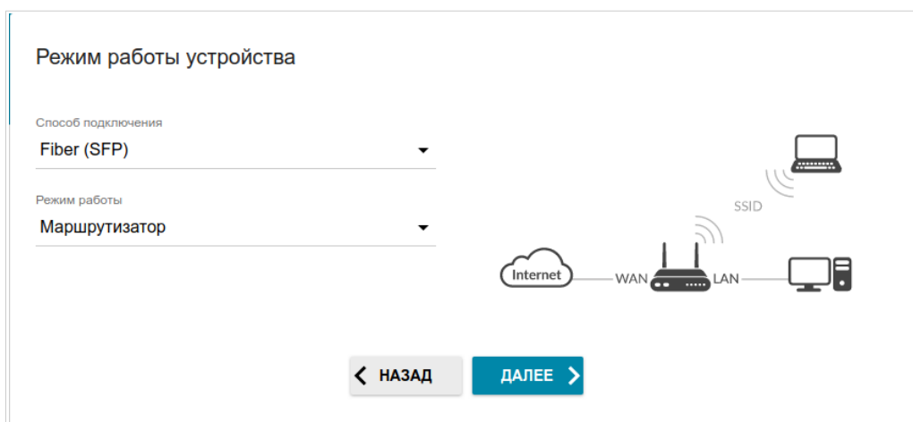
Рисунок 34. Выбор режима работы устройства. Режим Маршрутизатор .
