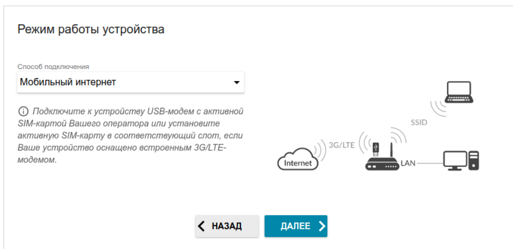
Рисунок 35. Выбор режима работы устройства. Режим Мобильный интернет .
