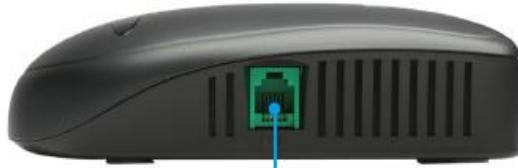
Телефонный порт FXO с разъемом RJ-11 для подключения телефонной линии
