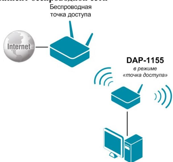
Устройство DAP-1155 в режиме «точка доступа» подключено к точке доступа по беспроводному соединению. Компьютеры подключаются к DAP-1155 через проводное или беспроводное соединение. Необходимо настроить один и тот же канал беспроводного соединения для DAP-1155 и удаленной точки доступа. Другие параметры беспроводной сети DAP-1155 не зависят от настроек удаленной точки доступа.
