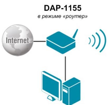
Устройство DAP-1155 в режиме «роутер» подключено к выделенной Ethernet-линии или к кабельному или DSL-модему. Компьютеры подключаются к DAP-1155 через проводное или беспроводное соединение. Необходимо настроить одинаковые параметры шифрования и канал беспроводной сети для DAP-1155 и компьютеров с Wi-Fi-адаптерами. Кроме того, для DAP-1155 необходимо настроить WAN-соединение.
