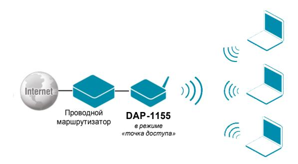
Подключите устройство к компьютеру кабелем, поставляющимся в комплекте. На сетевой карте, к которой подключено устройство, в настройках TCP/IP укажите IP-адрес -192.168.0.51 и маску подсети -255.255.255.0.
