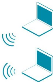
Устройство DAP-1360 в режиме «точка доступа» подключено к точке доступа по беспроводному соединению. Компьютеры подключаются к DAP-1360 через проводное или беспроводное соединение. Необходимо настроить один и тот же канал беспроводного соединения для DAP-1360 и удаленной точки доступа. Другие параметры беспроводной сети DAP-1360 не зависят от настроек удаленной точки доступа.
