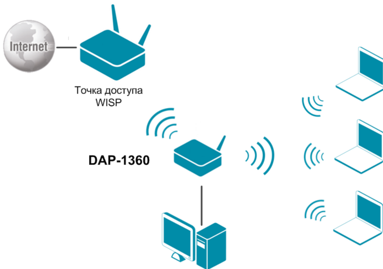
Рисунок 133. Подключение DAP-1360 в режиме маршрутизатора в качестве клиента.
