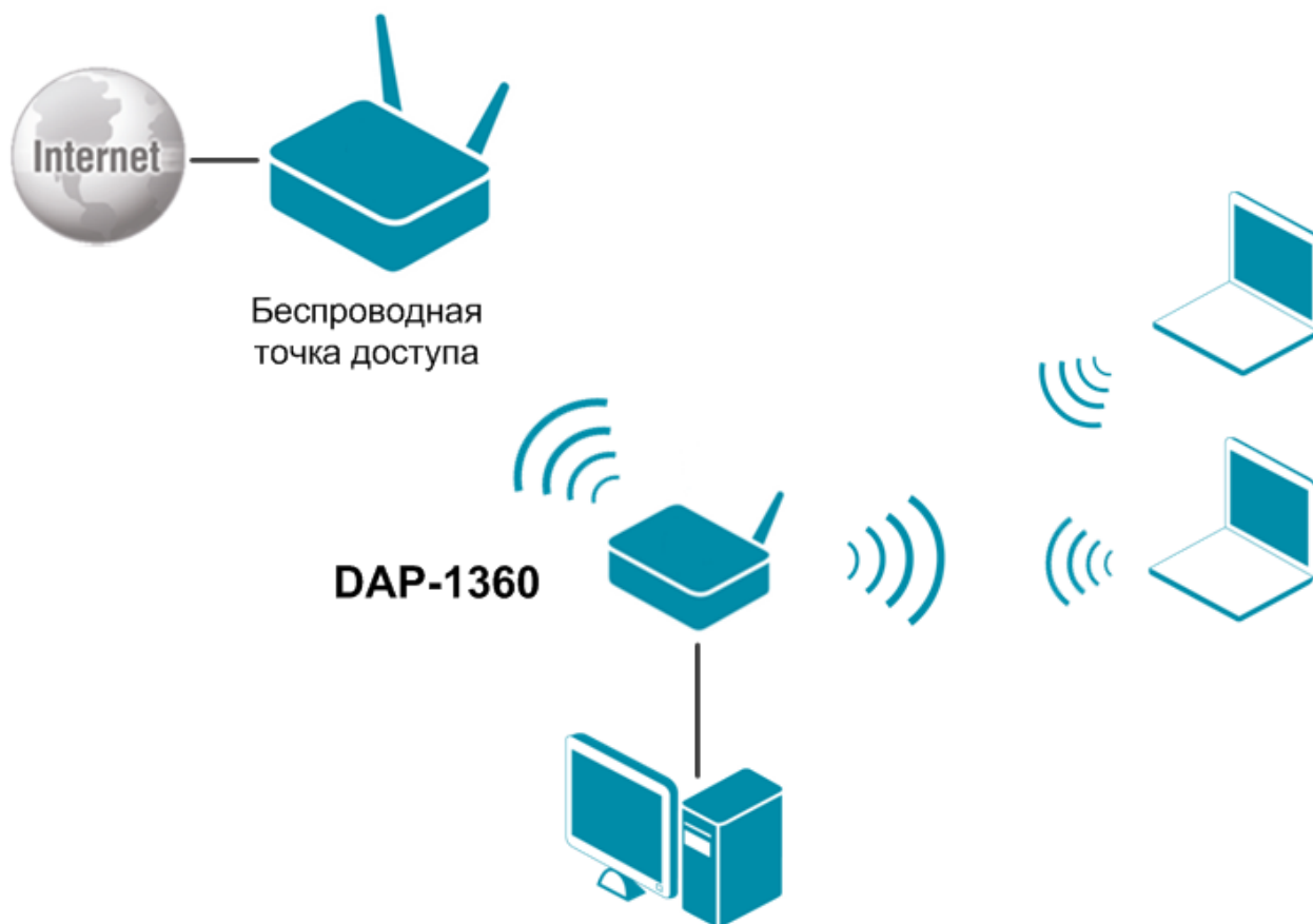
Рисунок 51. Подключение DAP-1360 в режиме точки доступа в качестве клиента.
