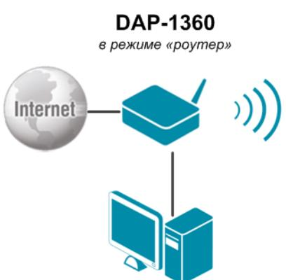
Устройство DAP-1360 в режиме «роутер» подключено к выделенной Ethernet-линии или к кабельному или DSL-модему. Компьютеры подключаются к DAP-1360 через проводное или беспроводное соединение. Необходимо настроить одинаковые параметры шифрования и канал беспроводной сети для DAP-1360 и компьютеров с Wi-Fi-адаптерами. Кроме того, для DAP-1360 необходимо настроить WAN-соединение.
