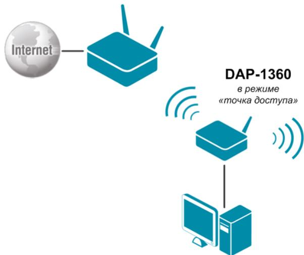
Устройство DAP-1360 в режиме «точка доступа» подключено к точке доступа по беспроводному соединению.
