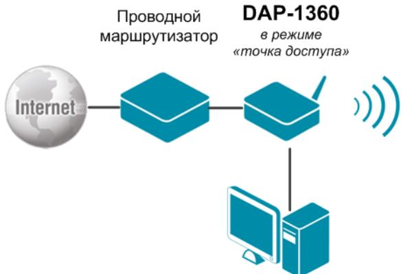
Устройство DAP-1360 в режиме «точка доступа» подключено к проводному маршрутизатору. Компьютеры подключаются к DAP-1360 через проводное или беспроводное соединение. Необходимо настроить одинаковые параметры шифрования и канал беспроводной сети для DAP-1360 и компьютеров с Wi-Fi-адаптерами.
