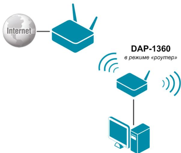
Устройство DAP-1360 в режиме «роутер» подключено к точке доступа беспроводного Интернет-провайдера (WISP) по беспроводному соединению. Компьютеры подключаются к DAP-1360 через проводное или беспроводное соединение.
