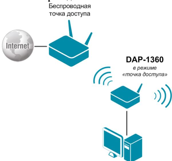
Устройство DAP-1360 в режиме «точка доступа» подключено к точке доступа по беспроводному соединению. Компьютеры подключаются к DAP-1360 через проводное или беспроводное соединение. Необходимо настроить один и тот же канал беспроводного соединения для DAP-1360 и удаленной точки доступа. Другие параметры беспроводной сети DAP-1360 не зависят от настроек удаленной точки доступа.
