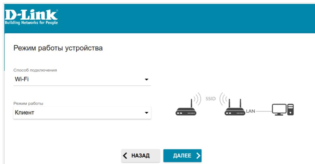
Рисунок 40. Выбор режима работы устройства. Режим **Клиент**.
