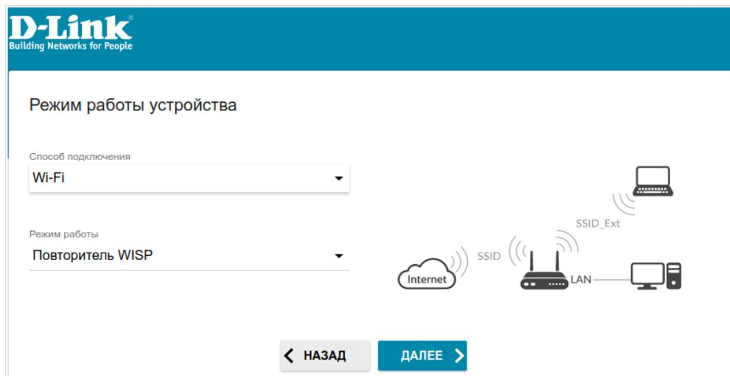
Рисунок 37. Выбор режима работы устройства. Режим **Повторитель WISP**.
