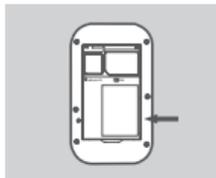
2. Обратите внимание, что имя беспроводной сети (SSID) и пароль указаны на этикетке под аккумулятором. При беспроводном подключении необходимо ввести данное имя беспроводной сети и пароль.
