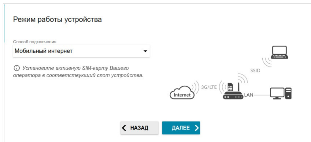
Рисунок 36. Выбор режима работы устройства. Режим Мобильный интернет .
