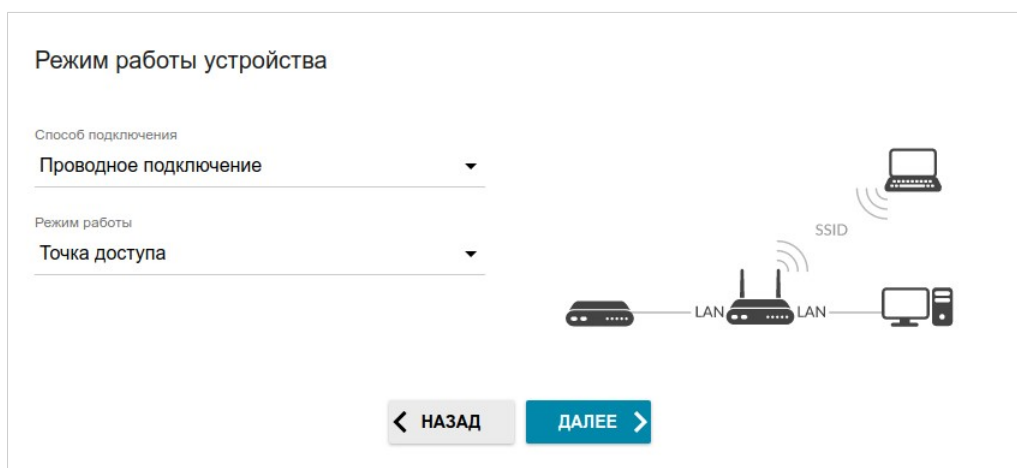
Рисунок 38. Выбор режима работы устройства. Режим Точка доступа .
