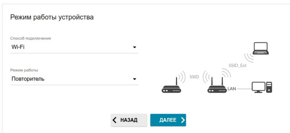
Рисунок 39. Выбор режима работы устройства. Режим Повторитель .
