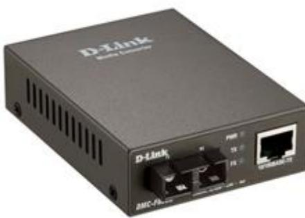
Данный медиаконвертер преобразует сигнал из стандарта 10BASE-T/100BASE-TX Fast Ethernet на витой паре в сигнал стандарта 100BASE-FX Fast Ethernet по одномодовому оптическому кабелю. Устройство оснащено 1 портом RJ-45 для витой пары и 1 оптическим портом с разъемом SC.
